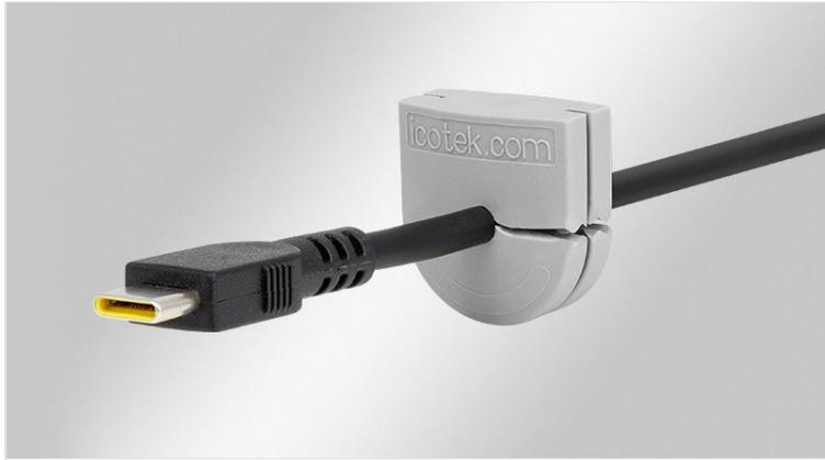
L'UT è un pressacavo con forma a "U" che consente di installare all'interno di scatole di derivazione, cavi con e senza connettori, con un diametro compreso tra 4 e 11 mm.
